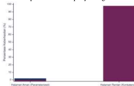
Gambar 4. Hasil perbandingan keberhasilan Parameterized Query (0%) dan Konkatenasi String (100%) dalam menangkal serangan Hasil perbandingan SQL Injection
